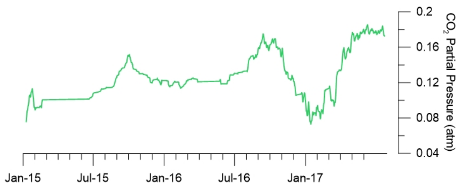
Figura 4 – Pressione parziale di CO 2 disciolta misurata dalla rete Etna Acque nella galleria drenante di Ponteferro (running average su base quindicinale).
