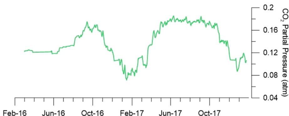
Figura 4 – Pressione parziale di CO<sub>2</sub> disciolta misurata dalla rete Etna Acque nella galleria drenante di Ponteferro (running average su base quindicinale).
